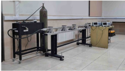
دستگاه تست فشار سرعت بالا (هایپکینسون بار فشاری) شرکت سازنده دستگاه: شرکت کاوش تجهیز کاسپین
