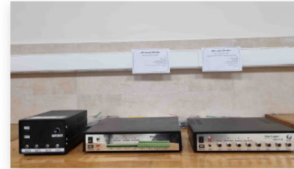
دیتالاگر استاندارد و کرنش سنج شرکت سازنده دستگاه: شرکت سفیر تریا
